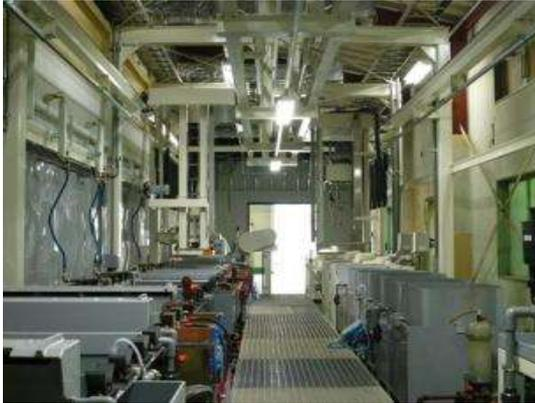
◆ 天吊りロボット自動搬送システム (Y,Z軸) ◆ めっき前処理 (脱脂・酸洗浄・水洗)
