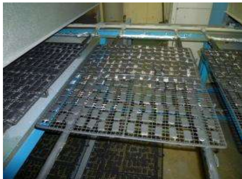
◆ 搬送は専用網（専用チェーン搬送） ・搬送スピード可変可能：200mm/分～700mm/分
