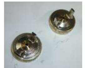
◆ ノズルガン4基/レシプロヘッド ・噴射角度・噴霧量調整可能
