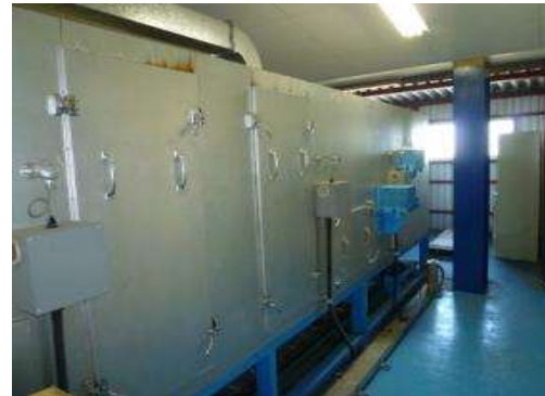
◆ 塗装後、遠赤外ヒーターによる乾燥を行います。
