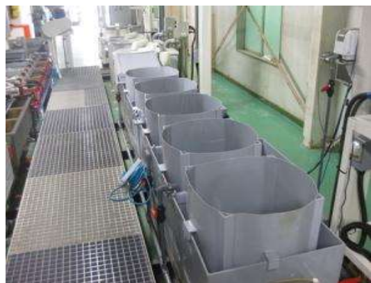
◆ 各洗浄槽バッチ処理 (攪拌・揺動)
