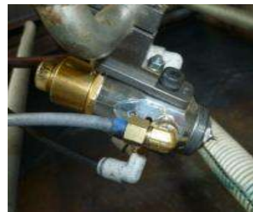
◆ ノズルガン4基/レシプロヘッド ・噴射角度・噴霧量調整可能
